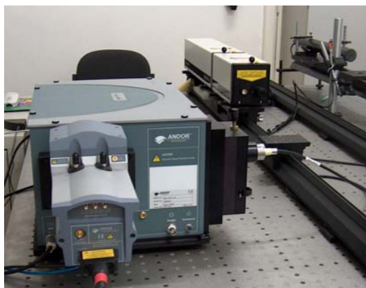
Fig. 20 Sistemul de detectie al semnalului de fluorescenta
