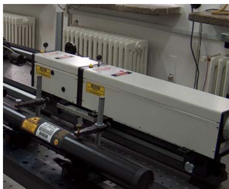
Fig. 19 Laserul cu mediu solid YAG:Nd si blocul de armonici
