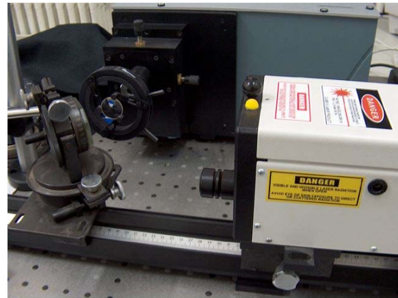
Fig. 18 Montajul experimental pentru LIF
