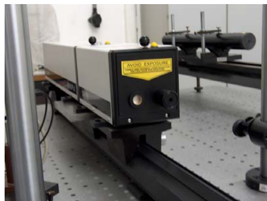
Fig. 19 Laserul cu mediu solid YAG:Nd si blocul de armonici
